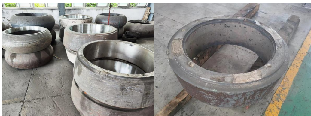
图 1 陶瓷金属复合磨辊辊套（主要有胎形辊套和锥形辊套两种）
