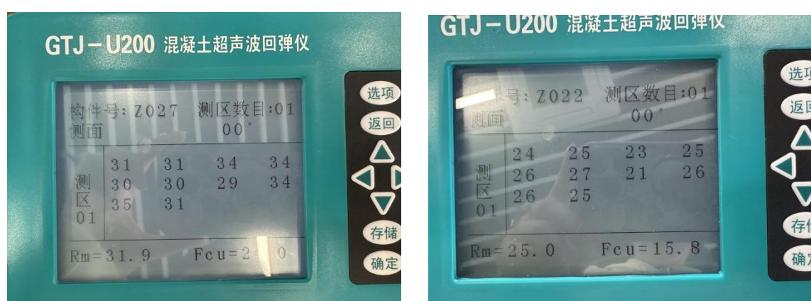
图 3 回弹值测试拍摄照片
