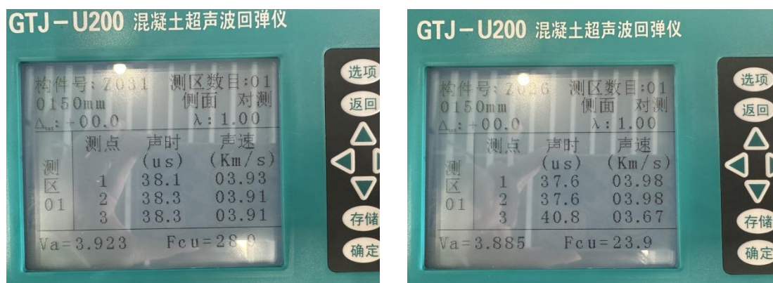
图 4 声速值测试拍摄照片
