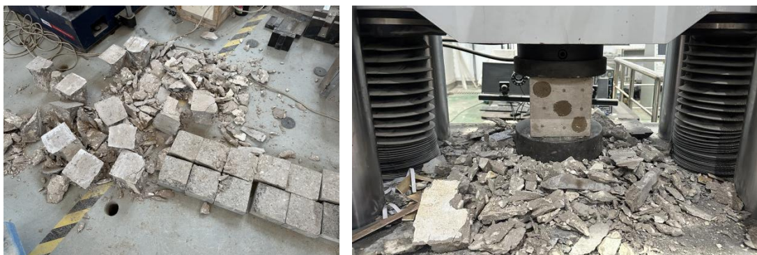
图 5 抗压强度测试拍摄照片
