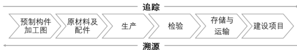
图2 预制构件质量追溯流程示意图
