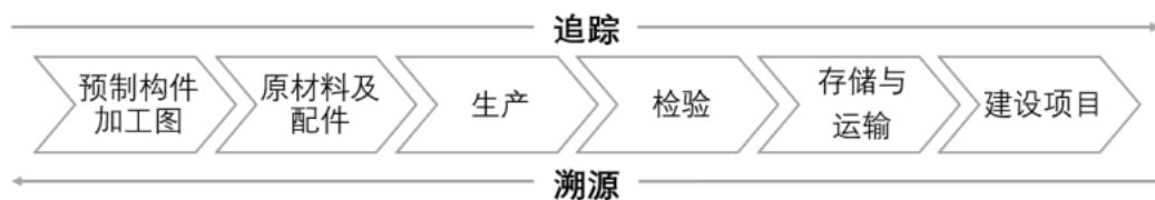
本章规定了预制混凝土构件的追溯流程。前端从预制构件加工图开始追溯，末端追溯到建设项目。重点解决了追溯过程中边界不清晰的问题。
