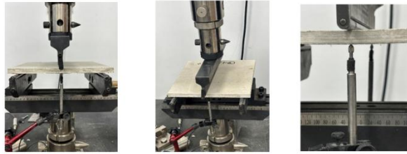
图 4 弹性模量测试图
