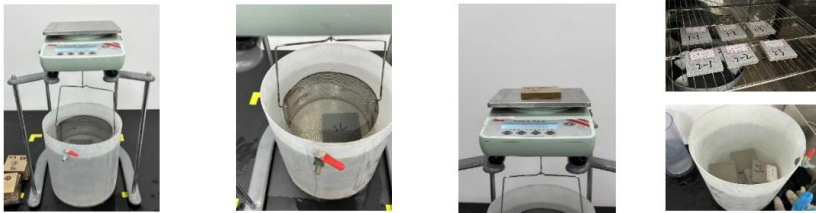
图 1 表观密度和吸水率试验图
