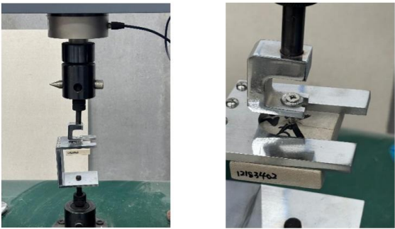
图 3 握螺钉力测试图
