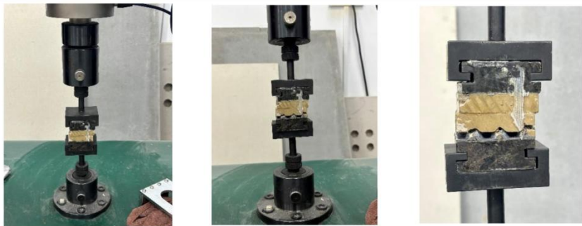
图 2 层间粘结力试验图
