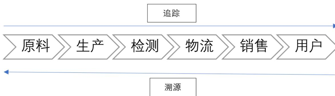
图2 纸面石膏板质量追溯流程示意图
